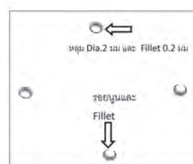
ภาพที่ 14 การออกแบบหลุมที่ตื้น หรือรอยนูนที่ตื้น ขนาดเล็ก และตัวอักษร
