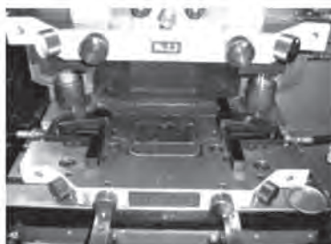
ภายหลังการปั๊มตัดเฉือน-ขึ้นรูปชิ้นงานเสร็จสิ้น การถอด ชิ้นส่วนแม่พิมพ์ออกจะเสร็จสมบูรณ์ภายในเวลาประมาณ 1 นาที
