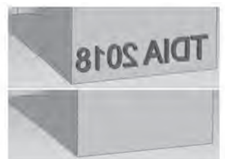
ภาพที่ 14 การออกแบบหลุมที่ตื้น หรือรอยนูนที่ตื้น ขนาดเล็ก และตัวอักษร
