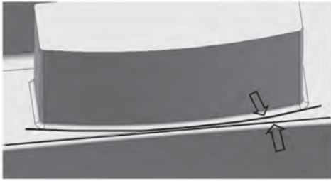
ภาพที่ 11 ขอบของพื้นผิวใกล้กันเกิดพื้นผิวแคบ ทำให้เกิด Silver mesh
