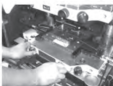
ทำการปรับปุ่มหมุนที่อยู่ทางด้านหน้า เพื่อให้การจับยึดคลายปลดล็อกชิ้นส่วนแม่พิมพ์
