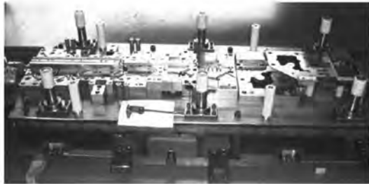
กรณีผลิตเป็นแม่พิมพ์โปรเกรสซีฟ จะใช้เวลาในการผลิตแม่พิมพ์ประมาณ 2 เดือน
