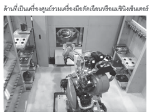
แขนกลนำแพลตฟอร์มชิ้นงานไปยังแมชชีนเซ็นเตอร์
