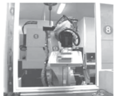
แขนกลนำชิ้นงานที่ผ่านการตรวจวัดไปจัดเก็บ
