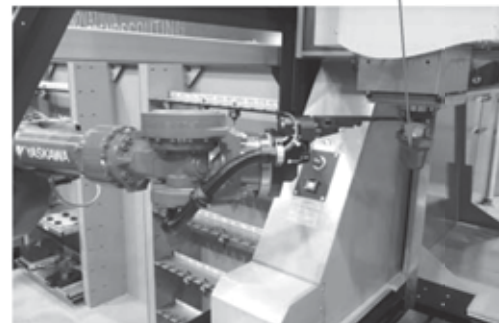
แขนกลถอดตัวจับยึดอิเล็กทรอนิกส์ออกจากเครื่องซีดีเอ็ม
