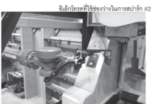
แขนกลนำตัวจับยึดอิเล็กทรอนิกส์มาติดตั้งเข้ากับเครื่องซีดีเอ็ม
