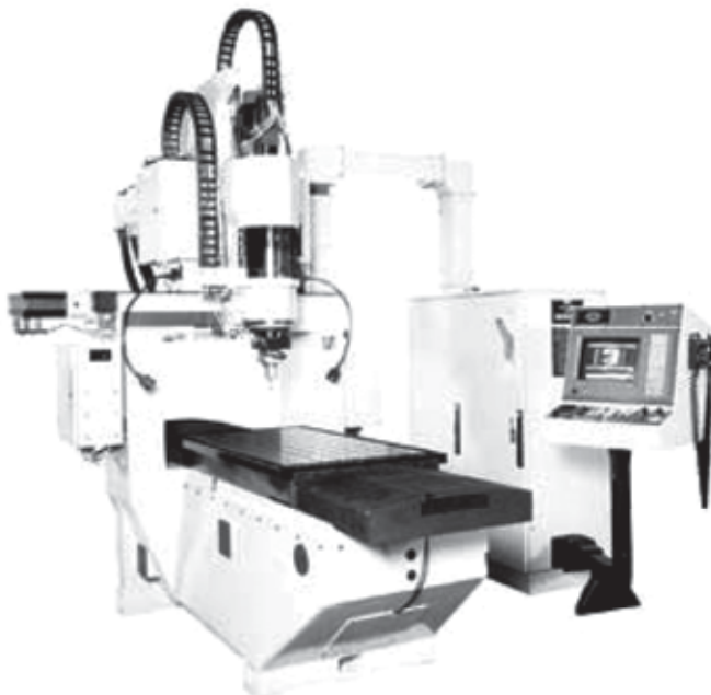
จิกไกรนด์เดอร์หรือเครื่องเจียเส้นรอบรูปโค้งเที่ยงตรงสูง "Moore"
