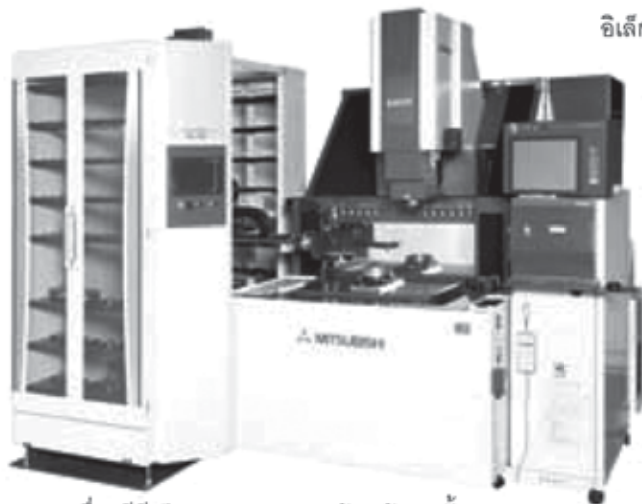
เครื่องอีดีเอ็ม "Mitsubishi" พร้อมตู้และชั้นวาง สำหรับเปลี่ยนอิเล็กโทรดหรือชิ้นงานโดยอัตโนมัติ
