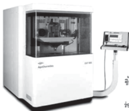
เครื่องไวร์คัต “AgieCharmilles” สำหรับผลิตชิ้นงานเที่ยงตรงจี้ระดับไมครอน
