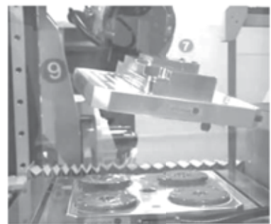
แขนกลนำชิ้นงานที่ตัดเฉือนเสร็จแล้วไปล้าง-อบ
