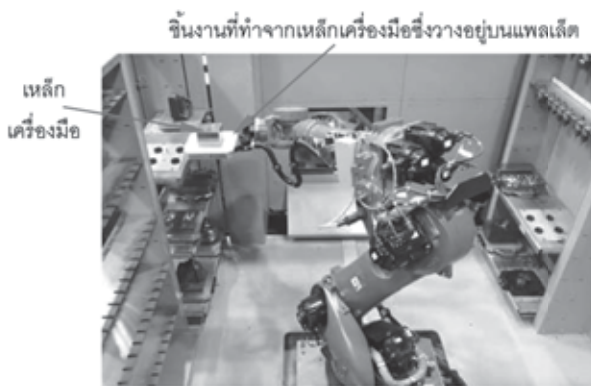
แขนกลหยิบ-จับแพลตฟอร์มชิ้นงานที่วางอยู่บนชิ้นวาง
